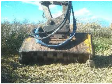
Braç de tractor triturant la part aèria de les canyes
